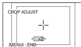
选择 [IN/OUT REC] 菜单中的 [CROP ADJUST]（第 68 页），确认显示出现后再次按 EXEC 按钮。然后，边缘裁剪标记会出现在显示器上。按  $\leftarrow/\rightarrow$  按钮左右移动标记，并调整裁剪位置。按 EXEC 按钮执行操作。
