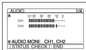
（显示两声道，即 1 和 2 声道的电平。）
