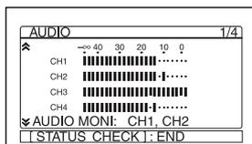
(播放声音的电平在 CH1 和 CH2 上显示。要复制的输入声音的电平显示在 CH3 和 CH4 上。当 AUDIO OUTPUT SELECT 开关设置为 MIX 时，声道组 1 和 3 以及声道组 2 和 4 的混合电平会显示。音频输出电平变为各声道原音频电平的 50% (-6 dB)。此时，电平表如本页上 (b) 所示。若要在复制之前只检查要复制的声音，则在本机处于停止模式时按 AUDIO DUB 按钮。电平表只有在为音频复制选择声道 (3 和 4 声道) 时波动。)
