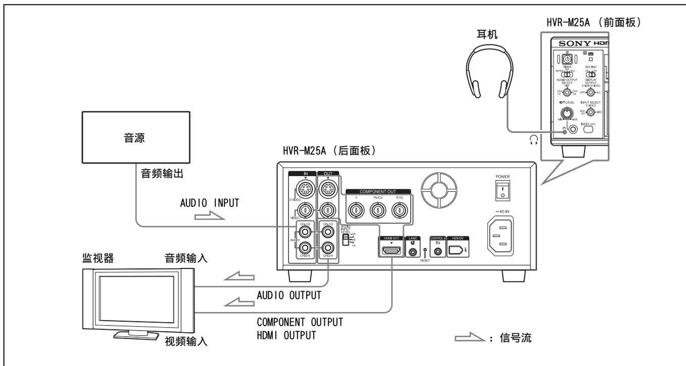
当您使用 HDMI OUT 插孔时，不需要用音频电缆进行单独连接。
