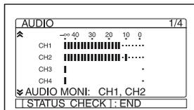
(显示四声道，即 1 至 4 声道的电平。在播放过程中，如果声音录制到 3 和 4 声道，对应的电平表有波动。不过，在正常录制过程中，无法将声音录制到本机的 3 和 4 声道。)
