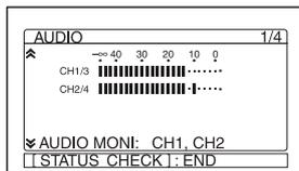
(1 和 3 声道的混合电平在 CH1/3 上显示；2 和 4 声道的混合电平在 CH2/4 上显示。音频输出电平变为原音频电平的 50% (-6 dB)。
